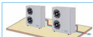
Conexión de dos unidades en serie.
