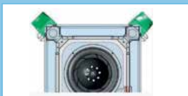
Es posible aportar aire fresco hasta un 15% del caudal de la unidad con una muy sencilla instalación opcional.
