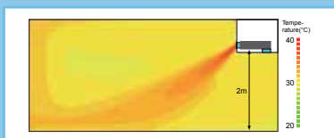
Impulsión de aire con Auto Louver.
