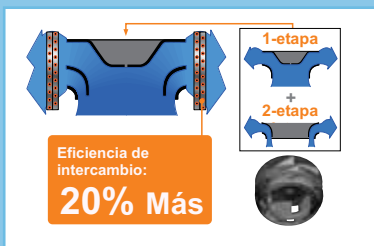
Ventilador de 2 etapas.
