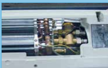
Válvula de 3 vías incorporada dentro de la unidad.
